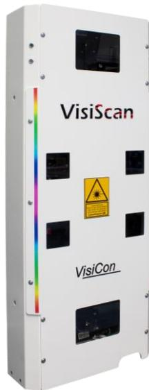
**VisiScan:** Unsere neueste 3D-Messsonde, die durch Laserscanner-Einheiten nur die relevanten Bereiche des Messobjekts dynamisch beleuchtet. Hieraus können alle wichtigen Fahrwerkskenngößen wie z. B. Spur, Sturz, Nachlauf, Spreizung, Fahrachswinkel etc. ermittelt werden.
