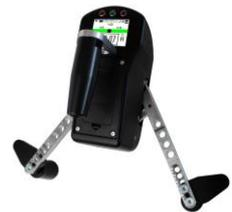
**Lenkradmesswaage VisiBalance:** Messung des Lenkeinschlags direkt am Lenkrad. Die zusätzliche Lenkwinkelmessvorrichtung ermöglicht die Bestimmung des Verhältnisses von Lenkwinkel zum Reifeneinschlag.
