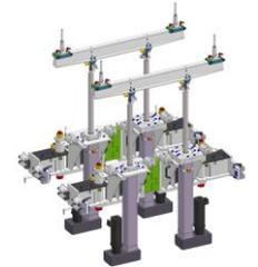
**Hub-Zug-Einheit:** Ermöglicht ein definiertes Niederziehen und Ausheben des Fahrzeugs, während Spur- und Sturzkurven über die Trimm lage aufgenommen werden. Über die optionalen Radlastwaagen kann das auch lastgesteuert erfolgen.
